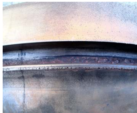
Figura 2: Vista exterior de la camisa, encontrándose una alta porosidad en la periferia del cilindro.
