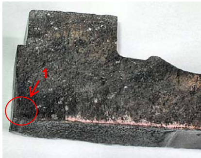
Figura 9: Vista de la región A, mostrando el sitio de nucleación de la grieta.
