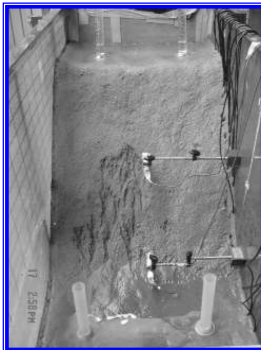
Figure 7. Transducer configuration to measure displacement. Model Test No. 07 Figura 7. Configuración de los sensores para medir desplazamiento. Modelo No. 07
