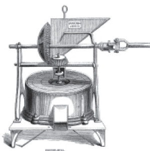
Figura 4. Máquina para descascarar café (fabricada por Barnes & Co., en Inglaterra), la cual era utilizada en fincas cafetaleras más grandes. Fuente: Thomas F. Meagher, Holidays in Costa Rica . Harper's New Monthly Magazine (1859-1860).
